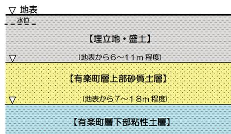
図 2-5 臨海部の埋立地盤の地層構成の例
