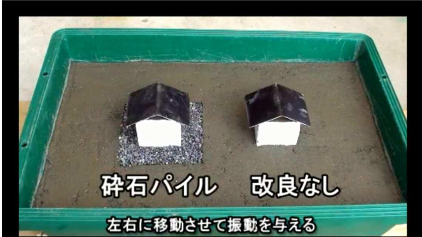
透水性の高い天然砕石を砂質土地盤に設置し、その排水効果によって地震時に砂質土地盤に発生する過剰間隙水圧を速やかに消散させ、地盤の液状化や液状化に伴う構造物の被害を防止する。
