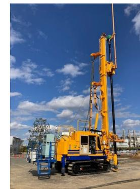
小型深層混合処理工法
